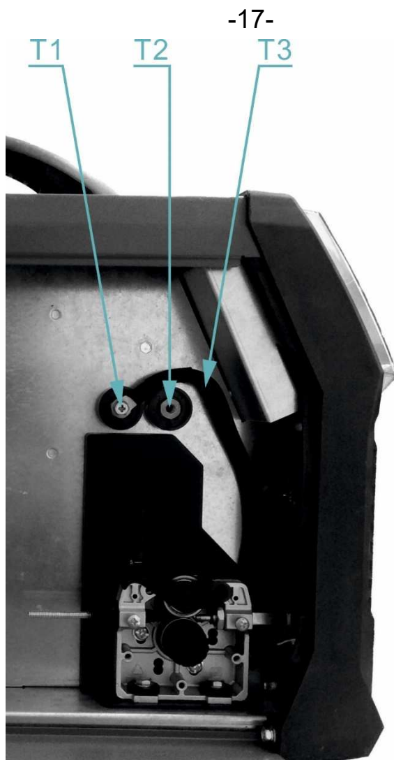
Obrázek 7 - Detail terminálů změny polarity MIG/MAG hořáku
